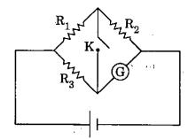
उपर्युक्त परिपथ में, प्रतिरोधकों के मान इस तरह हैं कि  $\frac{R_1}{R_2} = \frac{R_3}{R_G}$ , जहाँ  $R_G$  गैल्वनोमीटर का आंतरिक प्रतिरोध है । गैल्वनोमीटर का पठन
