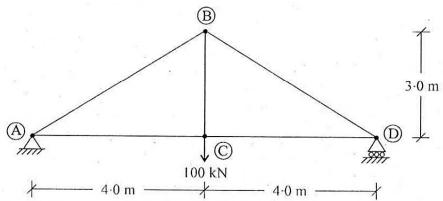
ऊपर दिये गये चित्र में प्लेन ट्रस (कैंची) के जोड़ B के लिए ऊर्ध्वाधर विक्षेपण का परिकलन एकल भार विधि के द्वारा कीजिए I ट्रस के सभी अवयव समांगी अनुप्रस्थ-काट एवं पदार्थ वाले हैं I Calculate the vertical displacement of joint B of plane truss given in the above figure by unit load method. All members of truss have constant cross-sectional area and same material (Constant A & E).
